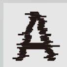
ステージドリフトや走査時の 振動による劣化した画像
