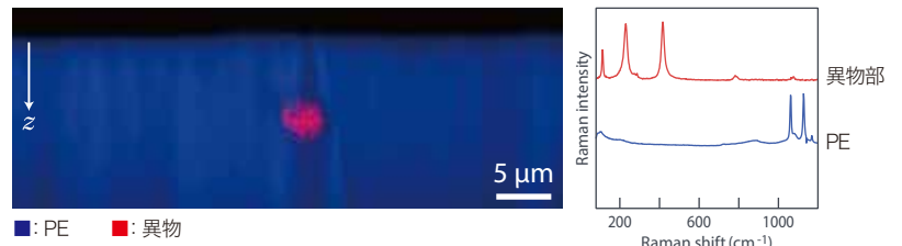
ポリエチレン (PE) フィルム中の埋没異物
